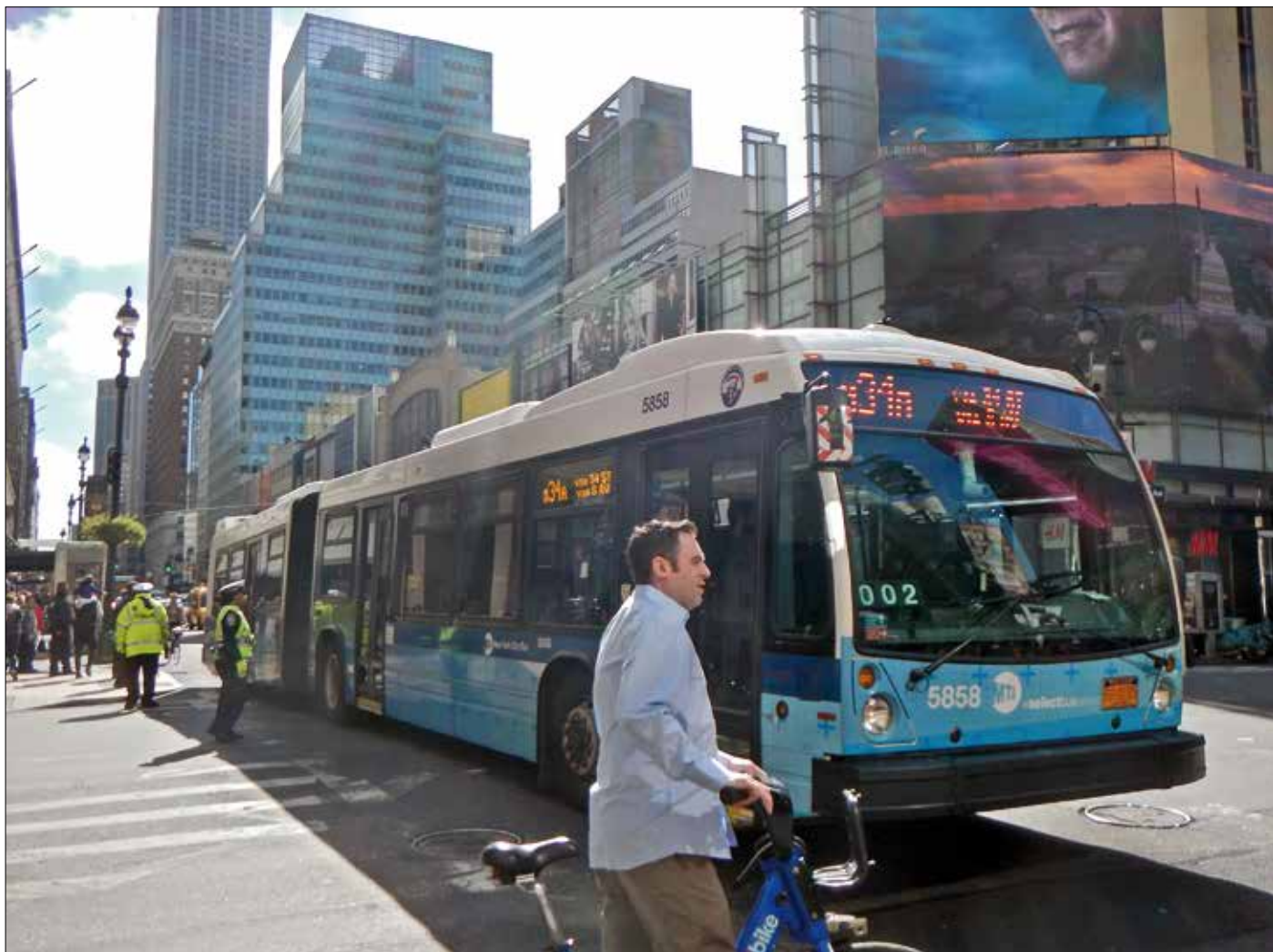
Nova Bus, LFS Artic (semi-low floor, articulated), nr 5858, med nioliters Cumminsmotor och ZF-automatväxellåda, en av 328 ledbussar levererade 2011–2013. Det finns sammanlagt omkring 5 770 bussar i New York. Av dessa drivs ca 700 av fossilgas och 1 600 är hybridbussar. Bussarna garageras i sammanlagt 28 depåer.
