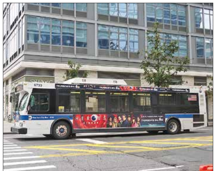
En hybridbuss tillverkad av Daimler-Chrysler, modell Orion VII (07.501). Det är en av sammanlagt 498 bussar tillverkade under åren 2006–2007.
