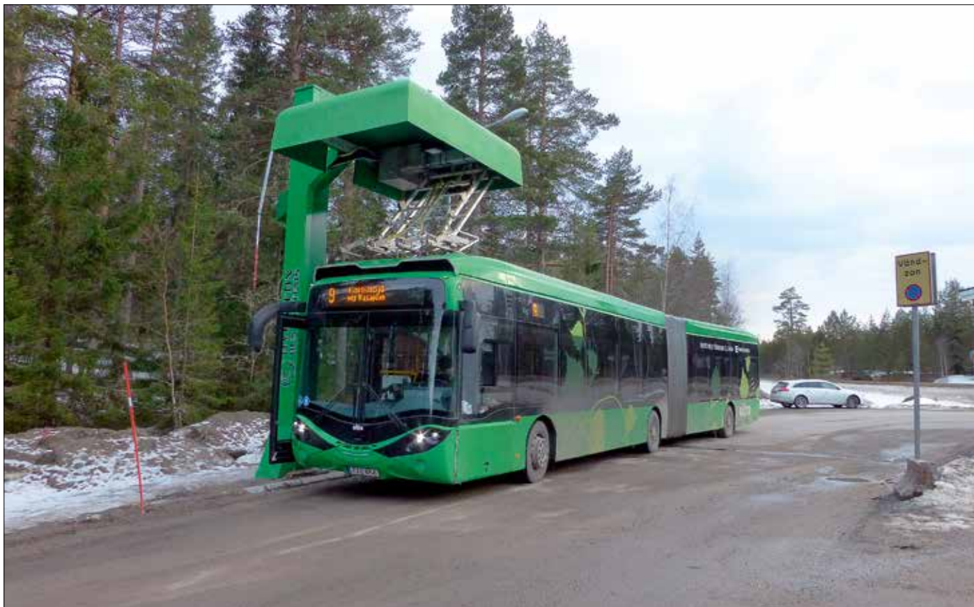
Rönneby ändhållplats för linje 9 med laddstation och batteriledbussen Nobina 2031. Laddning pågår som synes. Tekniska data för bussen framgår av tabell 2.
