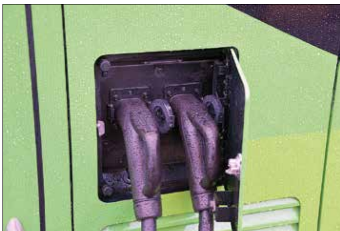
De båda laddkablarna kopplade i bussen.
