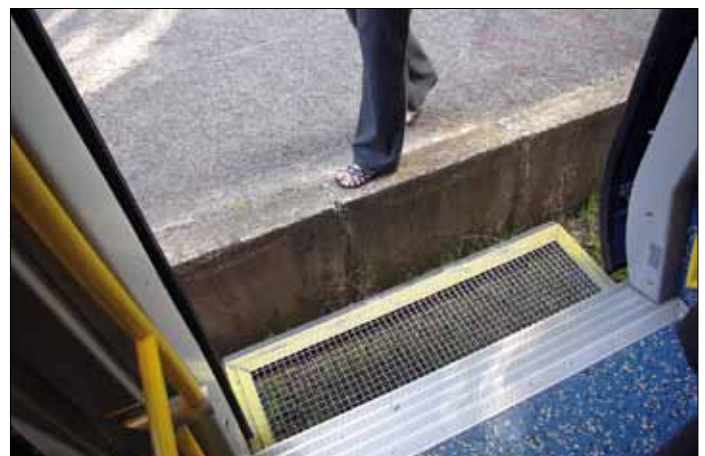
Se upp för både höjdskillnaden och avståndet mellan vagn och plattform! Just skillnader mellan plattformshöjd och instegsnivå är för duospårvagnar ett stort problem; det finns alltför många "standarder".
