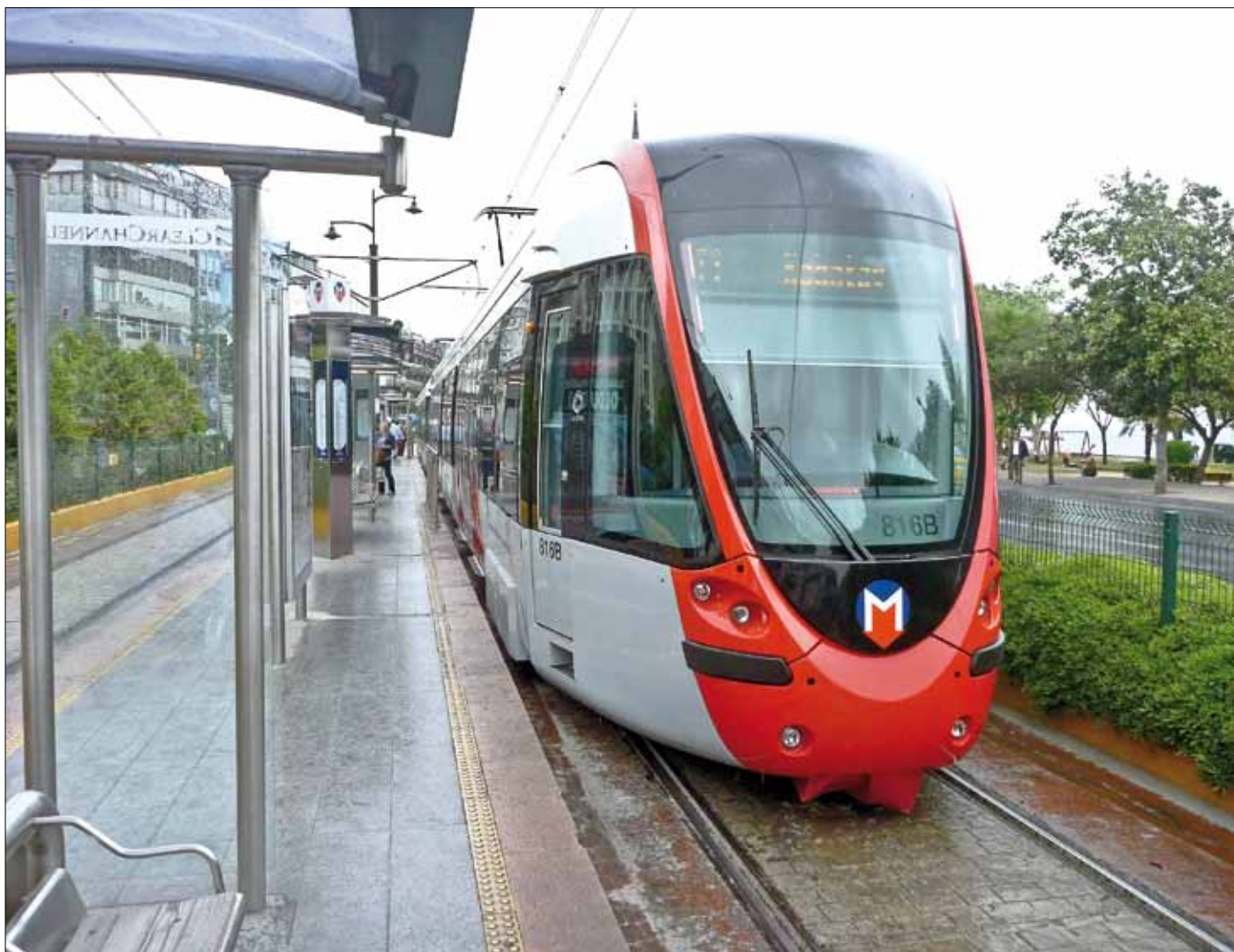
De 55 ursprungliga spårvagnarna kompletteras nu av 37 stycken Citadis 301, en spårvagnmodell med fullt vridbara boggiar under ändvagnarna. Också denna vagn typ körs i multipel. Det finns därmed sammanlagt 92 spårvagnar tillgängliga för trafiken på linje T1.
