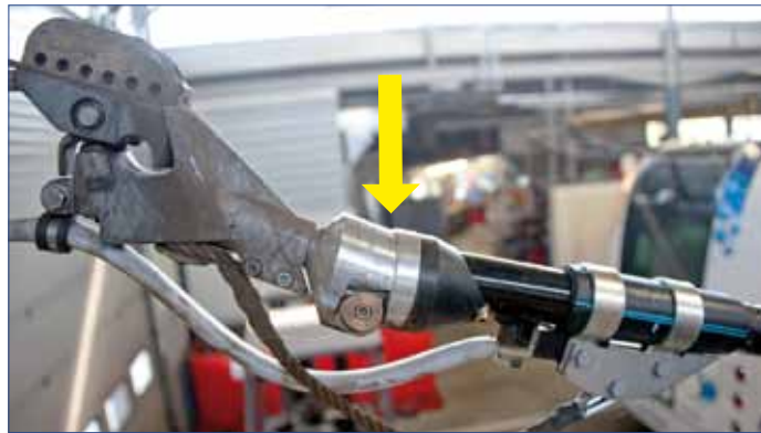
Om strömvtagaren hoppar av kontakttråden fjädrar stängens övre del tillbaka och kontakten vid pilen sluts, vilket sänder en signal till tryckluftcyldrarna vid stångfästet att omgående sänka stängen under ledningshöjd.
