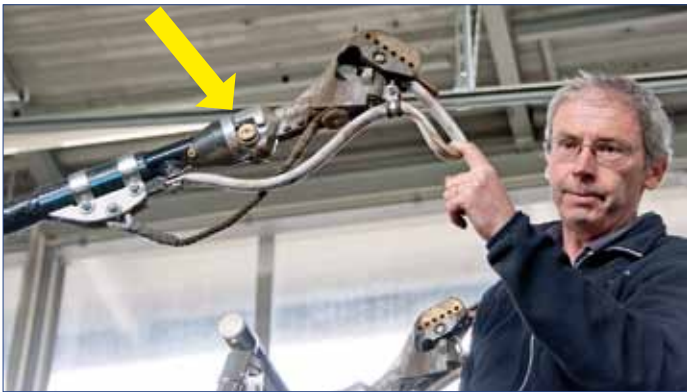
Michel Le Masson visar läget för strömvtagarens övre del när den ligger an mot kontakttråden: kontakten vid pilen är öppen, vilket medger normal drift.
