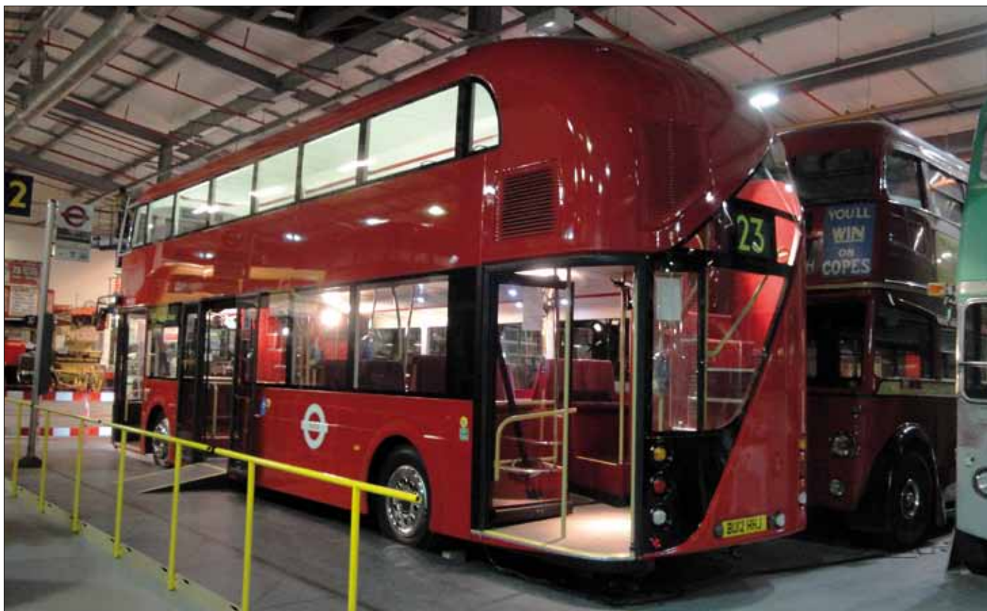
Fullskalemodell av den planerade nya dubbeldäckaren för London, med omisskännliga drag av Routemaster. Bussen kan användas både med och utan ambulerande konduktör. Vid enmansdrift stängs ingången till bakplattformen. På bilden är bakplattformen helt öppen. Bakre bakdörren som kan tillsluta ingången syns i bakfönstret. Främre bakdörren är fälld framåt mot skottet till kupén.
