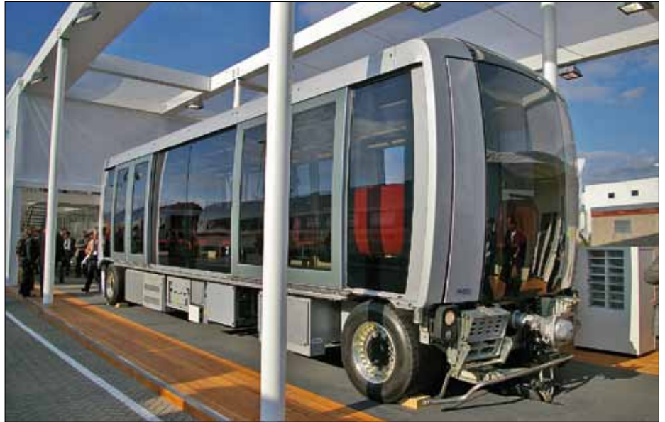
Cityval är ett helautomatiskt fordon på gummihjul som tillverkas i Alsace av Lohr Industrie (spårstyrning som på gummihjulsspårvagnen Translohr) och utrustas med Siemens autopilot. Någon månad efter Innotrans beställdes fordonstypen för den andra tunnelbanelinjen i Rennes, Bretagne.
