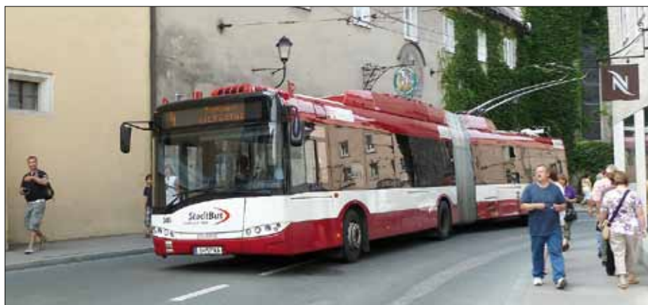
Sammanlagt 20 ledtrådbussar levereras under åren 2009–2012 från Solaris, med elektrisk utrustning från Cegelec, modell Solaris 18/Cegelec.
