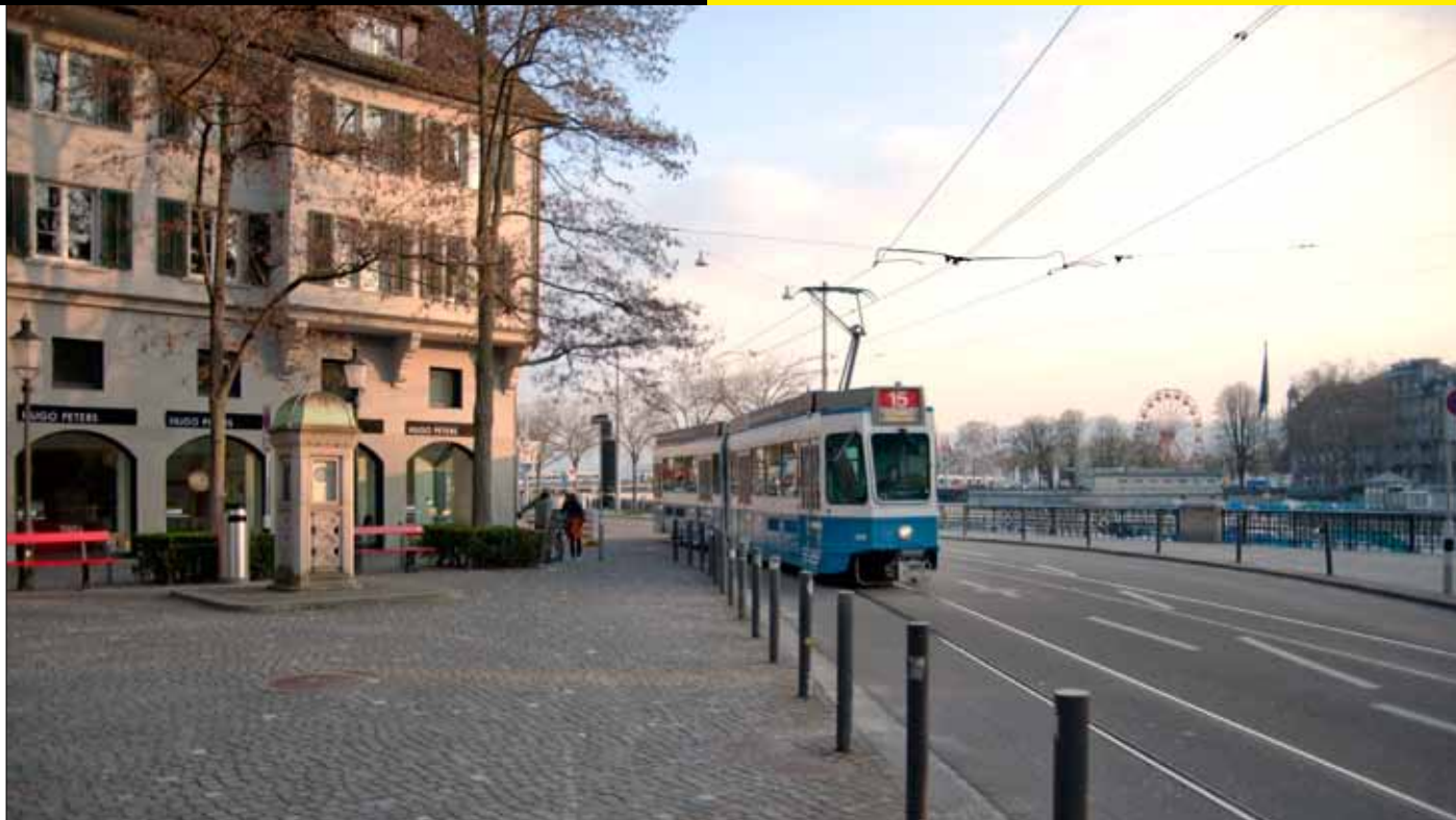
Spårvagn på Limmatquai i centrala Zürich. Kontaktledning med enkel körtråd, därtill dubbel förstärkningsledning mellan de båda färdriktningarna.
