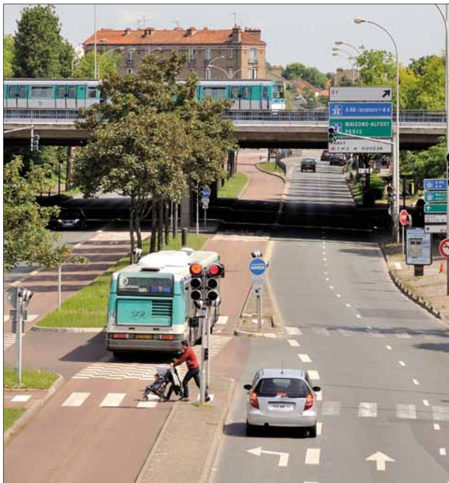
Busstekniken vid TVM är konventionell, utan exempelvis spårstyrning. Bussbanan är i regel väl avskild från angränsade körbanor för biltrafiken. Markbeläggningen på banan är oftast rödfärgad.
